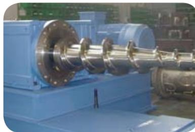
**Revisione settore di cilindro con ricambio bussola**
